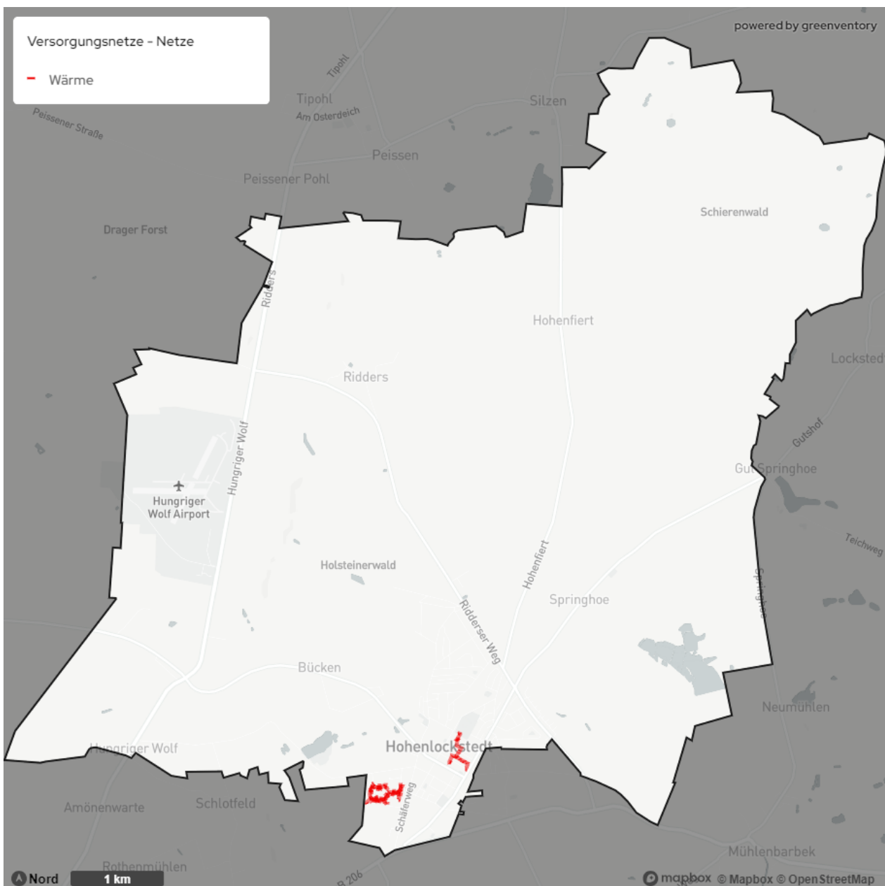
Abbildung 3-12: Wärmenetzinfrastruktur im Projektgebiet
