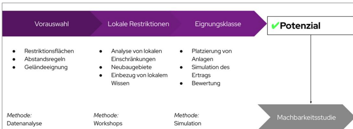
Abbildung 5-1: Vorgehen bei der Ermittlung von erneuerbaren Potenzialen
